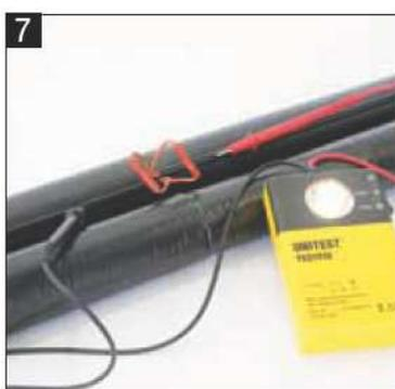
**7** Durchgangsprüfung der Fühlerleitung.
